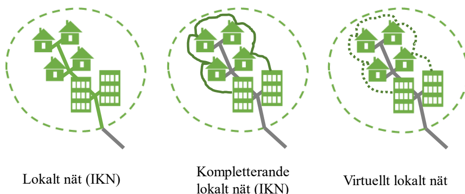
Figur 2: Stilistisk bild över de olika möjliga nätstrukturerna för delning av el, där lokalt nät innebär att en privat aktör helt tar över elnätet för distribution mellan användarna (IKN) och kompletterande lokalt nät (också ett IKN-nät) är en kompletterande ledning mellan huskroppar. Båda dessa utgör en fysisk infrastruktur. Det virtuella nätet efterliknar ett fysiskt nät i avseende flera funktioner, nyttjar istället en digital avräkning.
